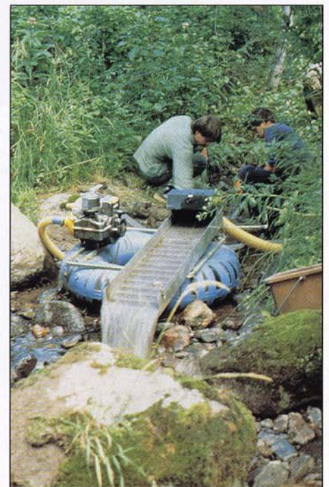
Sous la surveillance de Y.T. Maurice, des contractuels exécutent des travaux de dragage dans le cadre d'un levé de minéraux lourds dans la région de l'Estrie, au Québec. Photo : P.W.B. Friske
